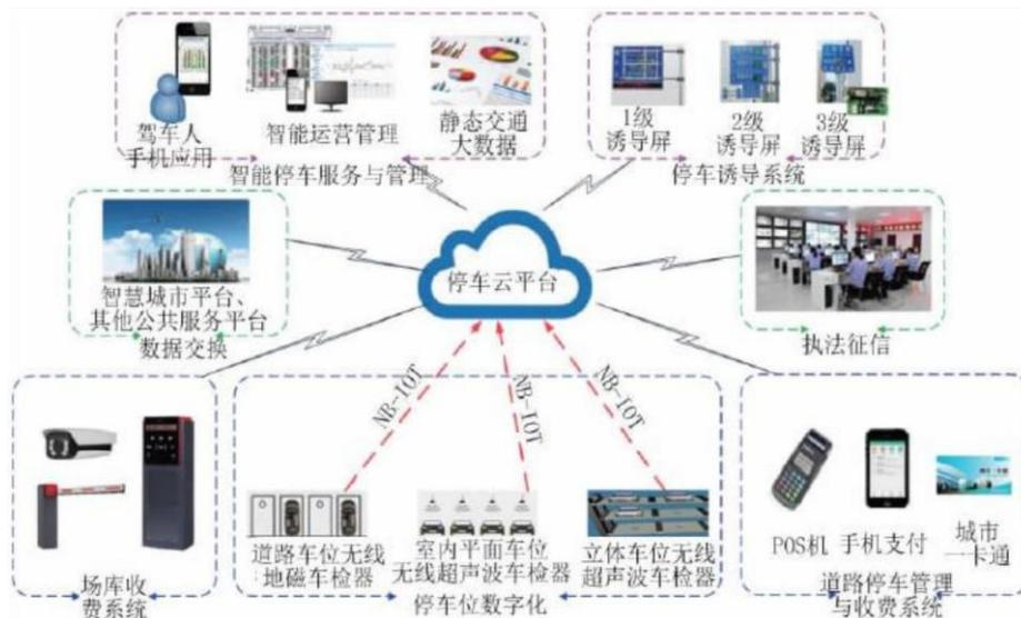
图 13-2 静态交通管理平台系统功能模块示意图
